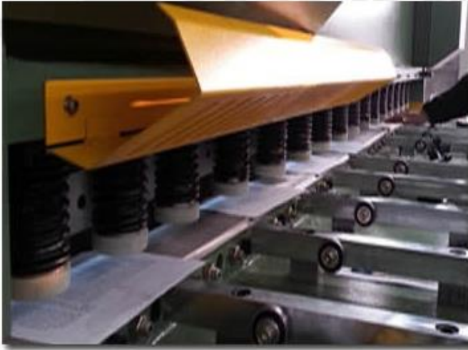
TEST rezanja papirja, postavite - odrezani kosi, za dokazilo natančnosti naprave zrač. i kakovosti nožev.
