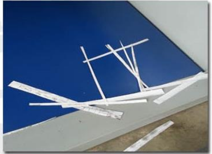
TEST rezanja papira, postavljanje i odrezani komadi, za dokaz preciznosti uređ. za zazor i kvalitete noževa
